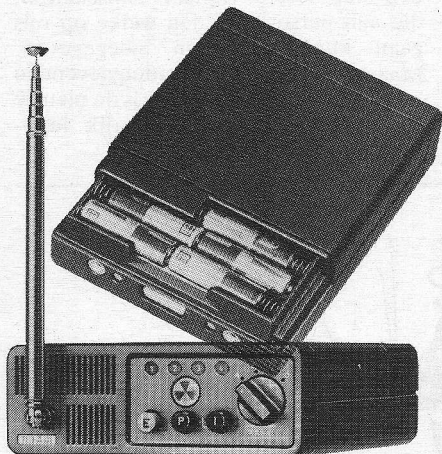
Fig. 2 en 3. De TEKADE oproepontvanger E 11-2. De voeding kan uit batterijen, accu's of lichtnet geschieden.
